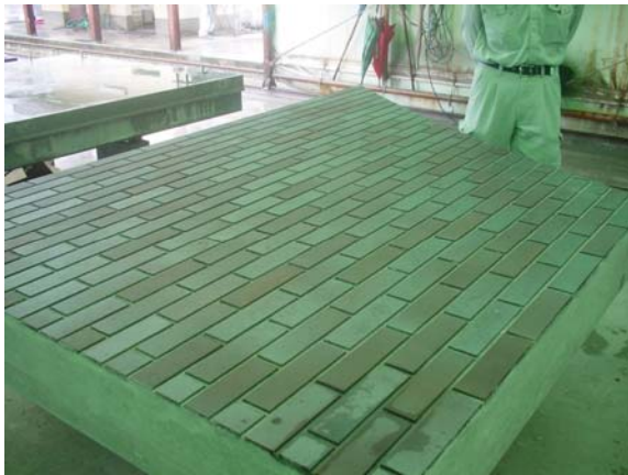
写真-4 工場での側壁ブロック
